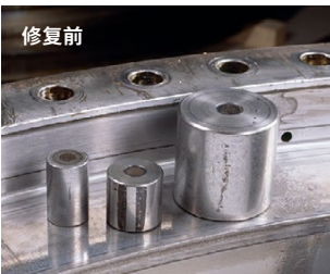
修复前 带有腐蚀痕迹和异物压痕的滚动体和滚道
