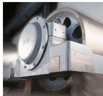
经济的解决方案： 挡轮和托轮整体单元
