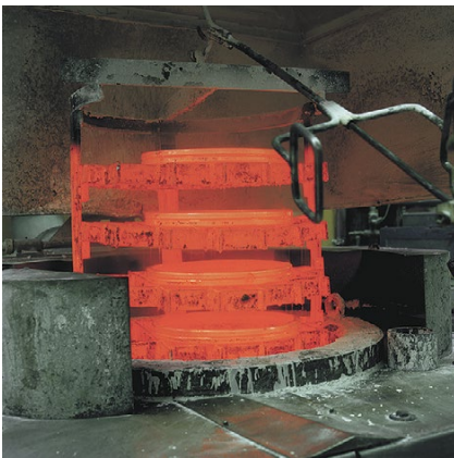
通过表面硬化处理提高耐磨性和抗疲劳强度
