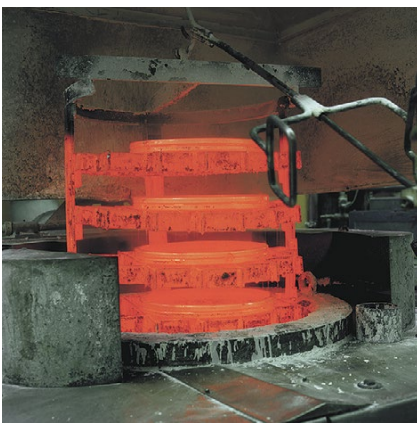
Augmentation de la résistance à l'usure et à la fatigue grâce à la cémentation
