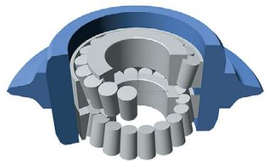
Calcul du roulement d'un disque de découpe avec le programme de calcul Bearinx de Schaeffler
