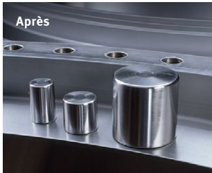
Après Piste de roulement rectifiée, nouveaux rouleaux avec serrage adapté
